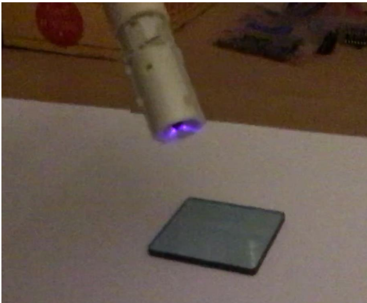
Obr. 2: Generátor studené plazmy za provozu, záměrně snímáno za minimálního okolního osvětlení
